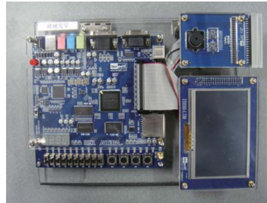
タッチパネル液晶モニタと CCD カメラを駆動したデジタルカメラの回路設計とシミュレーションツールによる回路動作確認
